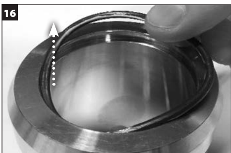
Fjern akslens O-ring (V) fra bøsningen og bortskaf.
