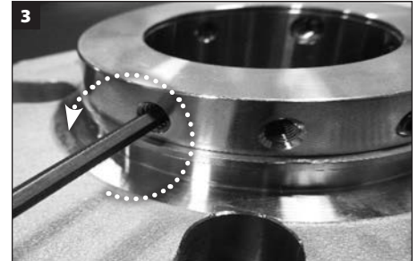
3 Fjern alle skruer med cylindrisk ende og 1/4 stillskruer fra låseringen og bortskaf.
