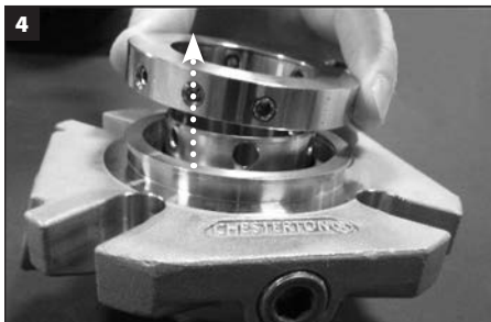
4 Fjern låseringen fra bøsningen og læg til side.
