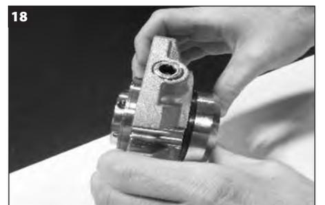
Levante la brida hacia arriba y sujete la parte inferior del cilindro para invertirlo y apoyarlo delicadamente de modo de iniciar el contacto entre las caras estacionarias y rotatorias.
