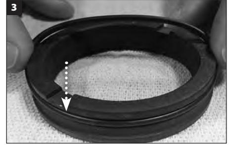
Aplique una película delgada de grasa blanca al O-Ring rotatorio (W) e instálelo en la ranura en el diámetro externo de la cara rotatoria. Asegúrese de que las almohadillas quedan en la parte posterior de la cara rotatoria.
