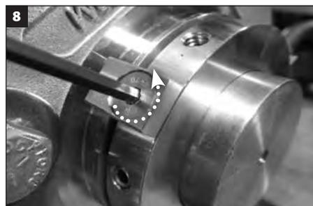
Retire todos los tornillos de cabeza plana y los clips de centrado, y guárdelos para usarlos después al hacer ajustes en el impulsor y/o desmontar el sello.
