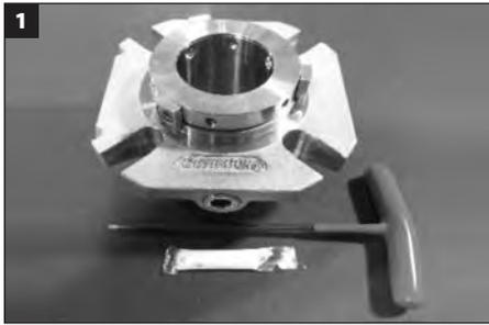
Herramientas requeridas para la instalación: Llave hexagonal y grasa blanca (suministradas con el sello); llave de extremo abierto o tubular (el tamaño depende del tamaño del perno de montaje); (suministrada por el cliente). **IMPORTANTE:** Puede accederse a los datos del sello mediante la etiqueta RFID instalada; también puede optar por completar la referencia a los datos del sello a partir de la etiqueta de la caja en la portada de estas instrucciones.
