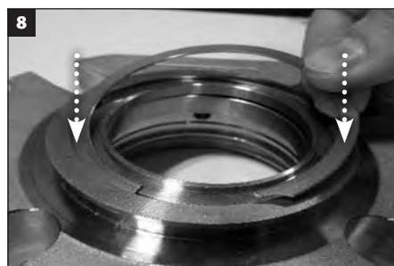
**Para sellos con el kit del buje:** Instale el anillo de presión sobre el buje y en la ranura de la brida para fijar el buje en la brida.
