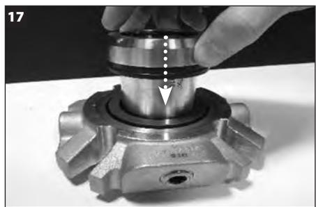
Invierta el conjunto del cilindro e insértelo en el orificio de la brida.
