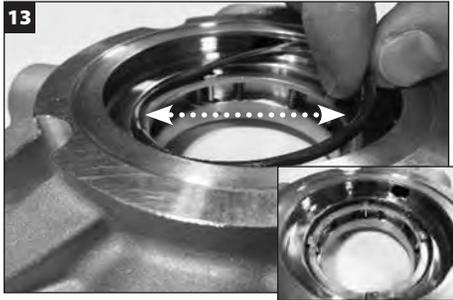
Aplique una película delgada de **grasa blanca** al O-Ring de la cara estacionaria (X) e instélelo en la ranura de la brida por arriba del conjunto de placa del seguidor.
