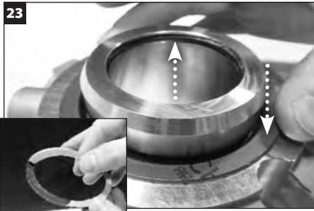
Aplique una película delgada de grasa **blanca** al O-Ring del eje (V) e instálelo en la ranura del diámetro interior del O-Ring del cilindro. Desprenda la cara adhesiva de la junta de la brida e instálela en el hueco para la junta de la brida.
