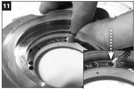
Sumerja los extremos de los resortes en grasa blanca e insértelos en cada orificio para resortes. **IMPORTANTE: NO inserte los resortes en los cuatro (dos) orificios uniformemente espaciados marcados mediante muescas y previamente llenados con grasa 635 SXC.**
