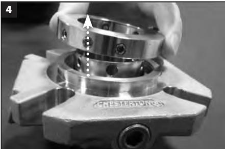
Retire el anillo de bloqueo para quitarlo del cilindro y apártelo.
