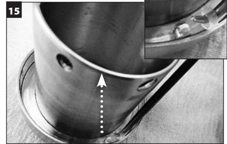
Déposez l'entraînement des pattes d'entraînement situées à l'intérieur de la chemise et mettez-le au rebut.
