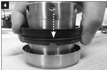
Alignez le repère de la face tournante avec l'encoche dans la chemise. Faites glisser la face tournante en bas de la chemise et compressez-la doucement jusqu'à ce qu'elle soit en butée. Les pattes d'entraînement de la chemise doivent s'engager dans les fentes de la face tournante. **AVERTISSEMENT : Ne compressez pas le tube d'entraînement.**
