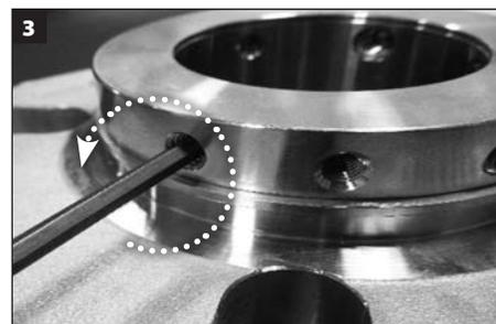
Déposez toutes les vis sans tête à cuvette et à téton 1/4 po de la bague de verrouillage et mettez-les au rebut.
