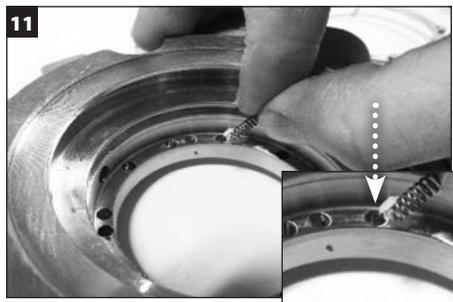
Plonger les extrémités des ressorts dans la graisse blanche et insérez-en un dans chaque orifice de ressort. **IMPORTANT : N'INSEREZ PAS de ressorts dans les quatre (deux) orifices espacés régulièrement, repérés par des cavités circulaires, et précédemment remplis de graisse 635 SXC.**
