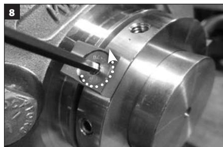
Lors des réglages de l'impulseur et/ou de la dépose de la garniture mécanique, retirez toutes les vis à tête plate et tous les clips de centrage, et mettez-les de côté pour une utilisation ultérieure.
