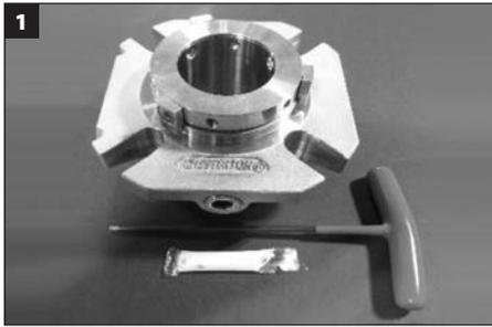
Outils nécessaires pour l'installation : clés à six pans et graisse blanche (fournies avec la garniture mécanique) ; clé à fourche ou à douille (taille selon celle des boulons de montage ; fournie par le client). **IMPORTANT : Les données de la garniture mécanique sont accessibles à partir de l'étiquette RFID apposée ; vous pouvez également choisir de remplir les informations de référence de la garniture mécanique sur la page de garde de ce manuel à partir de l'étiquette apposée sur la boîte.**
