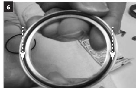
**Pour les garnitures mécaniques avec kit d'anneau de restriction :** Appliquez une fine pellicule de graisse **blanche** sur le joint torique (Y) et installez-le dans la rainure sur l'anneau de restriction en bronze. **IMPORTANT : Assurez-vous que le joint torique est complètement en butée et intégralement dans la rainure pour joint torique. Le joint torique peut sembler surdimensionné lors de l'installation et devra être inséré minutieusement.**
