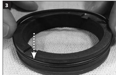
Appliquez une fine pellicule de graisse **blanche** sur le joint torique tournant (W) et installez-le dans la rainure du diamètre externe de la face tournante. Assurez-vous que les joints amortisseurs sont au dos de la face tournante.
