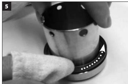
Nettoyez la face tournante avec un solvant agréé et un chiffon non pelucheux.
