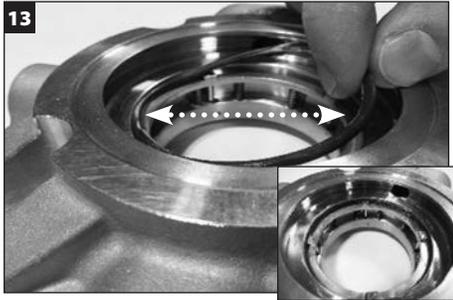
Appliquez une fine pellicule de graisse **blanche** sur le joint torique de la face stationnaire (X) et installez-le dans la rainure du chapeau au-dessus de l'ensemble de plaque de fouloir.
