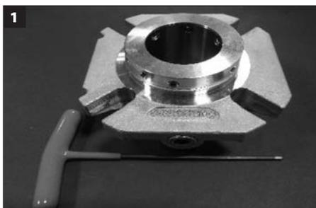
Outils nécessaires pour le démontage de la garniture mécanique : Clé hexagonale (**fournie avec la garniture mécanique**) ; une pincette et une pointe incurvée (**fournies par le client ; pour la dépose des joints toriques et du tube d'entraînement**).
