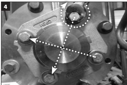
Stringere i bulloni della flangia in modo uniforme. **IMPORTANTE: I bulloni della flangia devono essere serrati prima di stringere le viti di fermo sull'albero. I valori di serraggio dei bulloni della cassa stoppa varia a seconda dell'applicazione. IMPORTANTE: I collegamenti non vanno effettuati prima di stringere i bulloni della flangia.**
