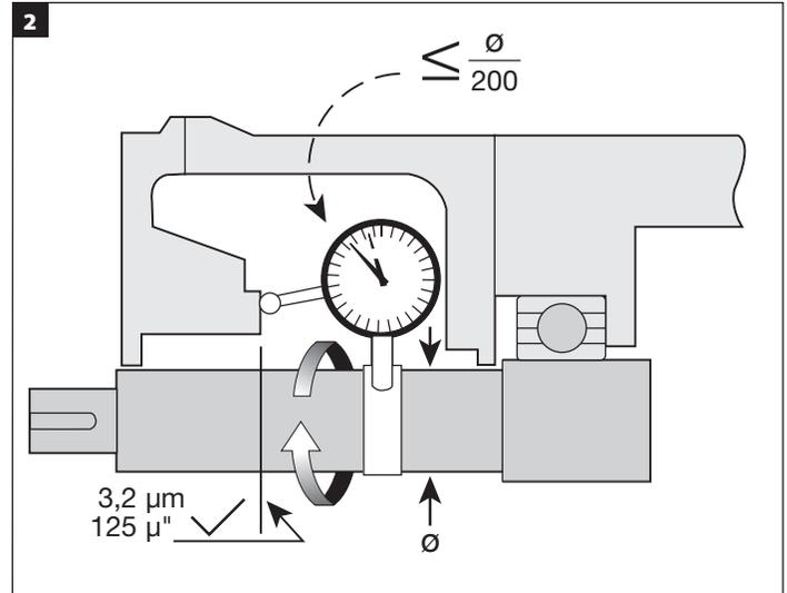
Se possibile, collegare all'albero la base di un comparatore, far ruotare lentamente l'albero ed il comparatore, leggendo contemporaneamente l'eccentricità della faccia della cassa stoppa. Il disallineamento della cassa stoppa rispetto all'albero non deve superare i 0,005 mm (0,005") TIR per millimetro di diametro dell'albero.
