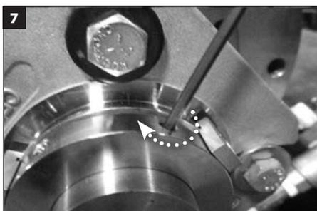
Stringere le viti di fermo con estremità a coppa (2) in modo uniforme con la chiave a brugola fornita. **IMPORTANTE: Dopo aver stretto tutte le viti di fermo a mano, stringerle nuovamente con una chiave dinamometrica:**
