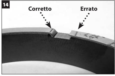
Accertarsi che gli ammortizzatori della faccia stazionaria siano installati correttamente, con la sezione sporgente sui bordi di rottura piegata sui lati delle scanalature.
