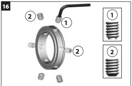
Installare le viti di fermo con estremità a coppa e cilindrica da 1/4 (1) nei fori delle viti contrassegnati da un incavo sul diametro esterno dell'anello di blocco. Installare le viti di fermo con estremità a coppa (2) nei fori rimanenti nell'anello di blocco. **IMPORTANTE: Le viti non devono sporgere nel diametro interno dell'anello di blocco prima dell'installazione nella bussola della tenuta.**
