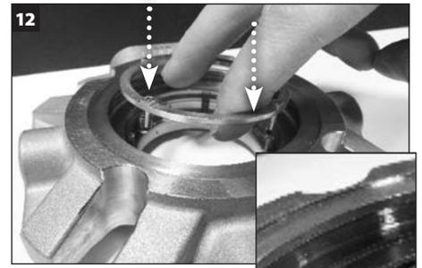
Allineare i perni sul piano della bussola con i fori sulla flangia riempiti di **grasso 635 SXC** e premere sul piano della bussola fino a che si appoggia alle molle.
