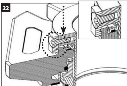
Premere sulla parte superiore della flangia per comprimere e girare ogni fermaglio di centraggio per incastrarlo nella scanalatura sopra alla flangia e stringere a mano le viti a testa cava esagonale incapsolata del fermaglio di centraggio. Ripetere questo punto per tutti i fermagli di centraggio. Stringere nuovamente con una chiave dinamometrica:
