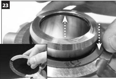
Applicare uno strato sottile di grasso **bianco** all'O-ring dell'albero (V) e installarlo nella scanalatura sul diametro interno della bussola. Staccare il supporto adesivo dalla guarnizione della flangia e installarla nell'incavo della guarnizione della flangia.
