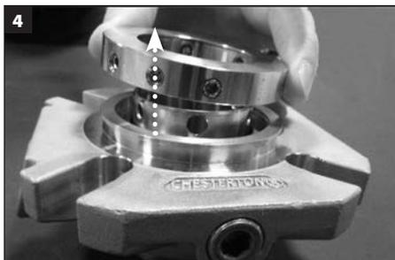
Rimuovere l'anello di blocco dalla bussola di usura e metterlo da parte.
