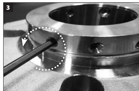
Rimuovere tutte le viti di fermo con estremità a coppa e cilindrica da 1/4 dall'anello di blocco ed eliminarle.
