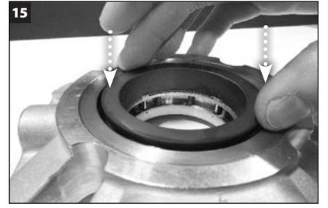
Allineare le scanalature sulla faccia stazionaria con le guide sul piano della bussola e premere delicatamente sulla faccia stazionaria fino a quando non è completamente inserita. **ATTENZIONE: Un allineamento errato comporta la scheggiatura sui bordi della scanalatura della faccia.** Pulire la faccia stazionaria con un panno senza filacce e con un solvente approvato conforme alle norme locali.
