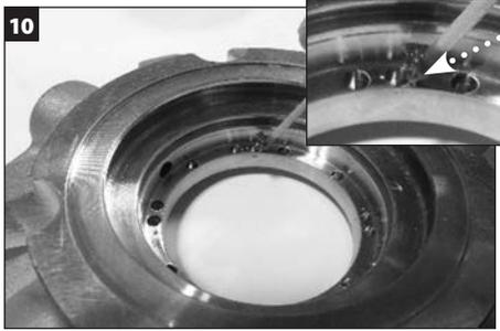
Riempire i quattro (o due, a seconda della dimensione della tenuta) fori uniformemente distanziati, contrassegnati da incavi, con il grasso **635 SXC** fornito con la tenuta. Eliminare il grasso in eccesso. **Suggerimento utile: Utilizzare il piano della bussola come guida per confermare l'applicazione del grasso nei fori corretti.**
