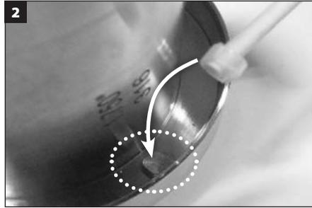
Prendere il tubo di azionamento (utilizzando le pinzette se necessario) e installarlo su ognuna delle guide nella bussola. Accertarsi che il tubo di azionamento sia ben posizionato sulle guide.
