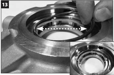
Applicare un sottile strato di grasso **bianco** all'O-ring della faccia stazionaria (X) e installarlo nella scanalatura nella flangia sopra al piano della bussola.
