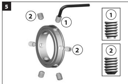
**IMPORTANTE: Le viti di fermo con estremità cilindrica da ¼ (1) devono essere strette PER PRIME e le viti di fermo con estremità a coppa (2) devono essere strette per ultime.** Le posizioni delle viti di fermo con estremità cilindrica da ¼ sono segnate da un incavo sul diametro esterno dell'anello di blocco, di fianco ai fori delle viti.
