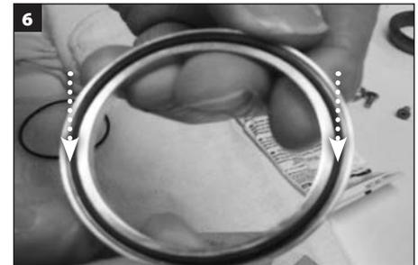
**Per le tenute con il kit boccola:** Applicare un sottile strato di grasso **bianco** all'O-ring (Y) e installarlo nella scanalatura sulla bussola di bronzo. **IMPORTANTE: Accertarsi che l'O-ring sia ben posizionato e completamente inserito nella scanalatura dell'O-ring. È possibile che l'O-ring sembri troppo grande quando lo si installa e che si debba faticare per inserirlo.**
