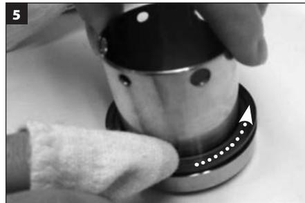
Pulire la faccia rotante con un solvente approvato e con un panno senza filacce.
