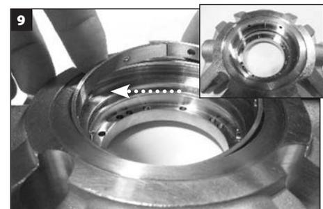
**Per le tenute con l'iniettore opzionale:** Capovolgere la flangia. Comprimere e sovrapporre le estremità dell'iniettore, posizionare le giunture opposte all'apertura F (flussaggio) e installarle nella scanalatura della flangia. **IMPORTANTE: L'iniettore deve incastrarsi saldamente. Accertarsi che le estremità non si sovrappongano al termine dell'installazione; effettuare delle regolazioni fino a che le estremità si congiungono.**
