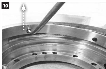
**Per le tenute con l'iniettore opzionale:** Togliere con attenzione l'iniettore e metterlo da parte.
