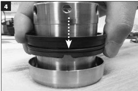
Allineare il segno sulla faccia rotante con la tacca sulla bussola. Far scorrere la faccia rotante sulla bussola e premere delicatamente fino a che è in posizione. Le guide della bussola devono incastrarsi con le scanalature sulla faccia rotante. **ATTENZIONE: Non comprimere il tubo di azionamento.**
