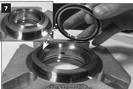
**Per le tenute con il kit boccola:** Installare la boccola nel controforo della flangia con l'O-Ring (Y) della boccola rivolto verso il basso.
