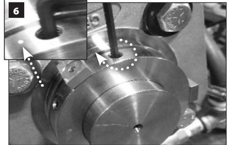
Stringere le tre viti di fermo con estremità cilindrica da ¼ (1) (vedere l'immagine, contrassegnata da un incavo) in modo uniforme con la chiave a brugola fornita.
