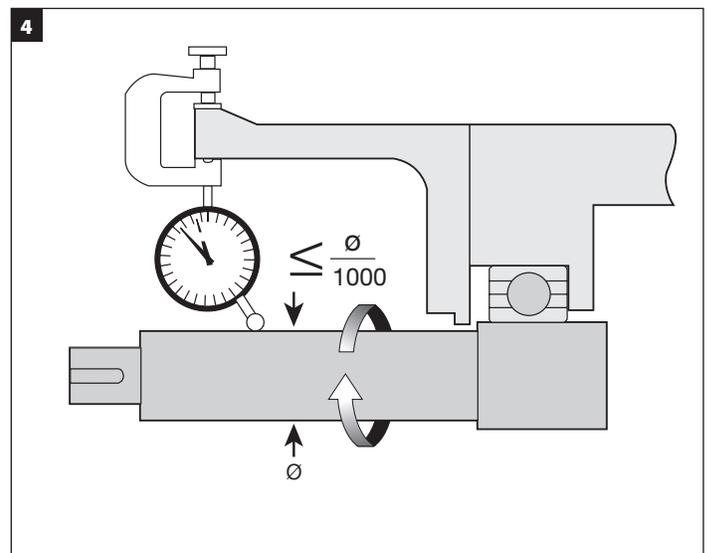
Usare un comparatore per misurare l'eccentricità dell'albero dove la tenuta deve essere installata. La lettura non deve superare i 0,001 mm TIR per mm (0,005") di diametro dell'albero.
