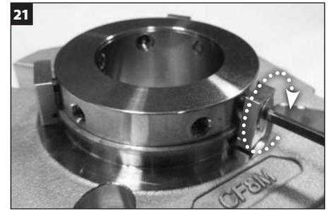
Installare i fermagli di centraggio sul diametro esterno dell'anello di blocco con le viti a testa cava esagonale incapsolata.
