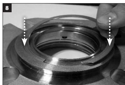
**Per le tenute con il kit boccola:** Installare l'anello elastico sopra alla bussola e nella scanalatura nella flangia per fissare la bussola nella flangia.
