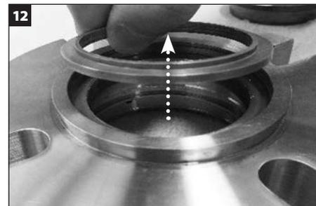
**Per le tenute con il kit boccola:** Rimuovere la boccola e l'O-ring della boccola (Y) dalla flangia ed eliminarli.
