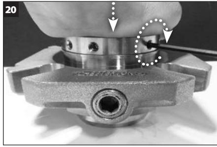
Premere delicatamente sull'anello di blocco e stringere le viti di fermo con estremità cilindrica da  $\frac{1}{4}$  e quindi le viti di fermo con estremità a coppa con la chiave a brugola fornita con la tenuta. **IMPORTANTE: Le viti di fermo devono essere strette a sufficienza per assicurare che siano ben fissate ma che non sporgano nel diametro interno della bussola.**
