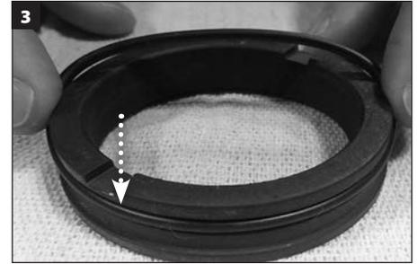
Applicare un sottile strato di grasso **bianco** all'O-ring della faccia rotante (W) e installarlo nella scanalatura sul diametro esterno della faccia rotante. Accertarsi che gli ammortizzatori siano sul retro della faccia rotante.
