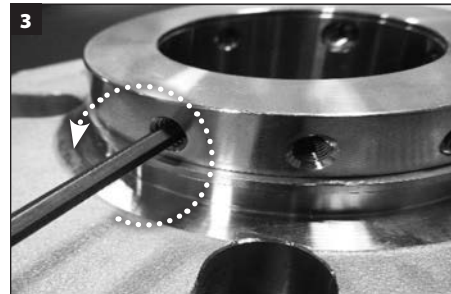
Verwijder alle grijppuntstelschroeven en 1/4 stompe stelschroeven van de borgring en gooi ze weg.
