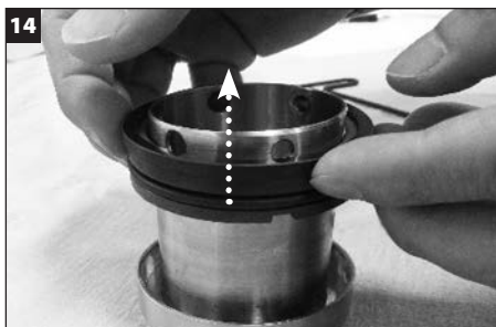
Wyjąć z rękawa obrotowy pierścień uszczelniający i wyrzucić.
