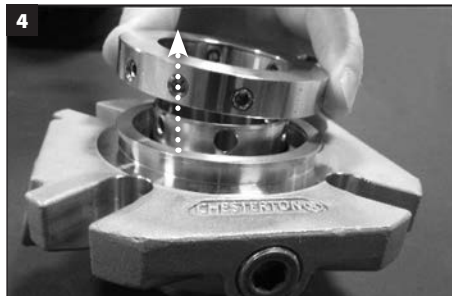
Wyjąć pierścień zaciskowy z rękawa i odłożyć.
