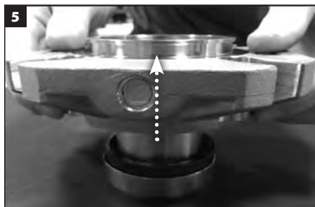
Separe a luva da sobreposta e coloque a luva de lado.
