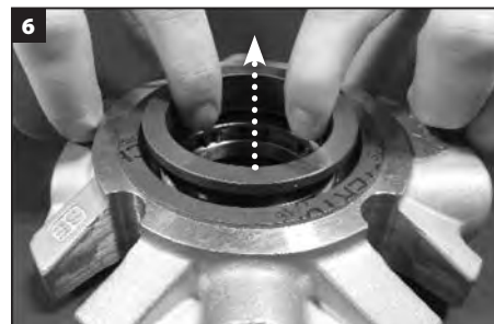
Remova e descarte o anel de selo estacionário interno da sobreposta.
