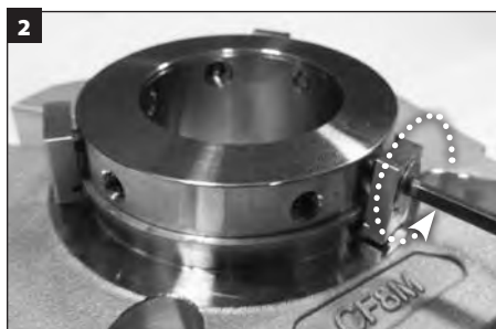
Remova e descarte os grampos de centragem.
