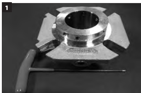
Ferramentas necessárias para a desmontagem do selo: chave sextavada ( fornecida com o selo ); pinças e uma ferramenta fina de ponta curva ( fornecidas pelo cliente para a remoção de O-rings e do tubo de acionamento ).
