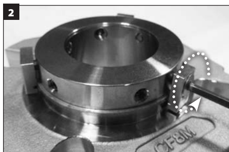
Remova e descarte os grampos de centragem.
