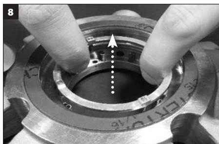
Remova o conjunto de seguidor da sobreposta e coloque-o de lado.
