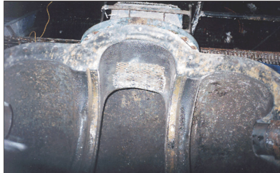
Superficies dañadas de la bomba.
