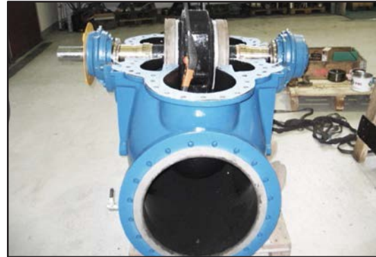
Superficie recubierta con ARC e impulsor con balanceo dinámico.
