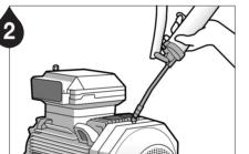
Asegure un paso libre usando pistola de engrase manual. **Nota 1:** Remueva gasa endurecida purgando manualmente el punto de lubricación con la pistola de engrase manual. Nota 2: La grasa del equipo y la grasa contaminada en la unidad deben ser la misma grasa o compatible.
