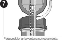
alinee el § en la tapa de la carcasa con el triángulo en el cuerpo.
