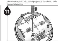
Desatornille los tornillos y remueva la tapa de la batería.
