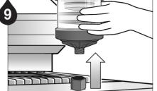
Cuando el periodo de dispensación del Lubri-Cup haya completado, remueva el lubricador de la aplicación
