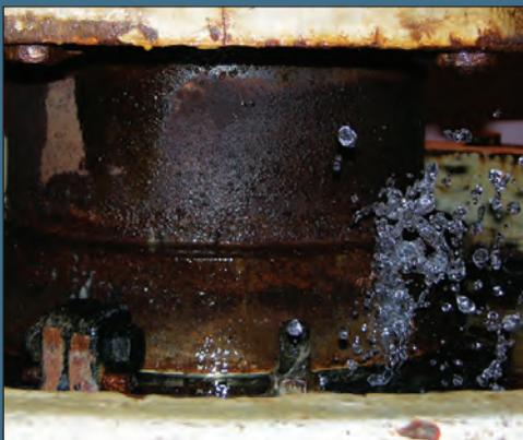
プロセス液の漏れは機器の腐食とベアリングの早期故障を招きます
