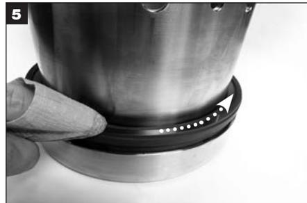
Die Gegenringfläche mit einem zugelassenen Lösungsmittel und einem fusselfreien Tuch reinigen.
