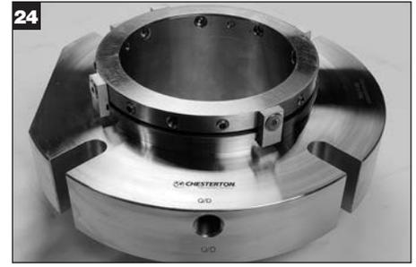
Die Dichtung ist für die Montage bereit.
