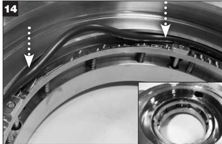
Eine dünne Schicht **weißes** Schmierfett auf den Gleitring-O-Ring (X) auftragen und diesen in der Nut im Dichtungsflansch über der Mitnehmerplatte montieren.
