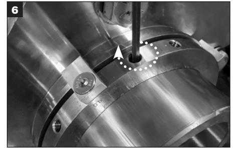
Die drei Ansatz-Einstellschrauben ① (siehe Bildeinsatz, durch Grübchen gekennzeichnet) mit dem mitgelieferten Sechskantschlüssel gleichmäßig festziehen.
