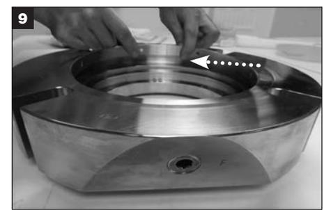
**Für Dichtungen mit Einspritzringoption:** Den Dichtungsflansch umdrehen. Die Enden des Einspritzrings zusammendrücken und überlappen; die Fuge gegenüber des Spülanschlusses (F) positionieren und den Einspritzring in die Dichtungsflanschnut einbauen. **WICHTIG: Der Einspritzring muss einschnappen. Sicherstellen, dass sich die Enden im vollständig montierten Zustand nicht überlappen.**
