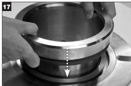
Die Hülsenbaugruppe umdrehen und in die Dichtungsflanschbohrung einsetzen.
