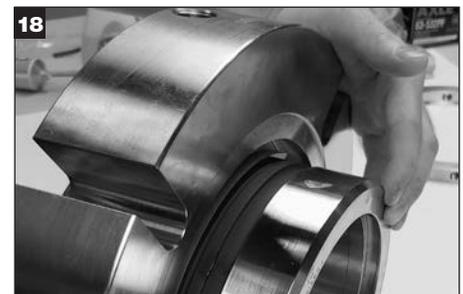
Am Dichtungsflansch nach oben ziehen und die Unterseite der Hülse beim Umdrehen halten; behutsam ablegen, um Kontakt zwischen der Gleitringfläche und der Gegenringfläche herstellen.
