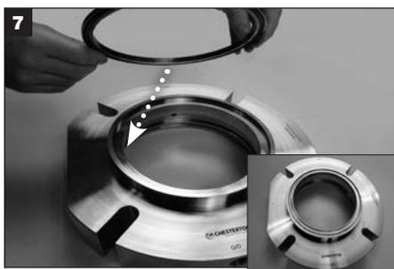
**Für Dichtungen mit Hülsensatz:** Die Hülse mit dem Hülsen-O-Ring (Y) nach unten in die Ansenkung des Dichtungsflansches einbauen.
