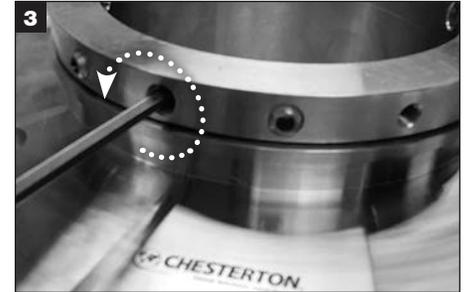
Alle Ringschneide- und Ansatz-Einstellschrauben aus dem Klemmring entfernen und entsorgen.
