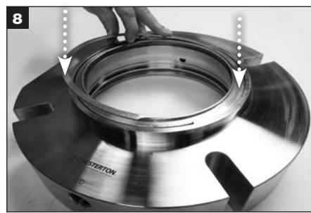
**Für Dichtungen mit Hülsensatz:** Den Sprengling oben auf der Hülse anbringen und in die Nut im Dichtungsflansch einsetzen, damit die Hülse im Dichtungsflansch gesichert wird.
