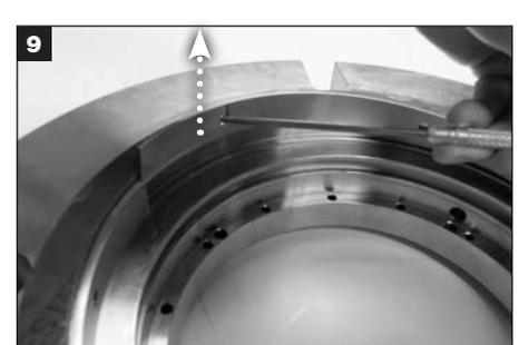
Alle Federn aus den Klemmringlöchern entfernen und entsorgen.
