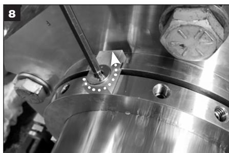
Alle Flachkopfschrauben und Zentrierklammern entfernen und zur späteren Verwendung bei der Laufadjage und/oder beim Dichtungsausbau aufheben.
