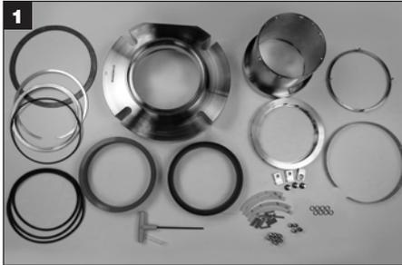
Zum Zusammenbau der Dichtung erforderliche Werkzeuge: Sechskantschlüssel und zwei Sorten Schmierfett (mit Dichtung mitgeliefert); fusselfreies Tuch, Pinzette und dicker Stift (vom Kunden bereitgestellt; zum Einbau der O-Ringe und des Mitnehmerrohrs). Alle Metallteile mit einem zugelassenen Lösungsmittel, einschließlich alle Dichtungen und O-Ringflächen, reinigen. Die Metallkomponenten und alle Komponenten der Ersatzdichtung auf eine saubere, trockene Fläche legen.
