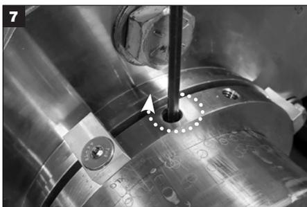
Die Ansatz-Einstellschrauben ② mit dem mitgelieferten Sechskantschlüssel gleichmäßig festziehen. **WICHTIG: Nachdem alle Einstellschrauben von Hand festgezogen wurden, müssen sie mit einem Drehmomentschlüssel festgezogen werden: bis 13,6 – 15,3 Nm (120 – 135 in-lbs)**
