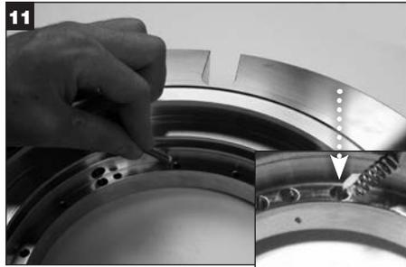
Die Federenden in weißes Schmierfett eintauchen und danach in die einzelnen Federlöcher einsetzen. **WICHTIG: Die Federn NICHT in die vier Löcher in gleichmäßigem Abstand einsetzen, die durch Grübchen gekennzeichnet sind und früher mit 635 SXC Schmierfett gefüllt wurden.**
