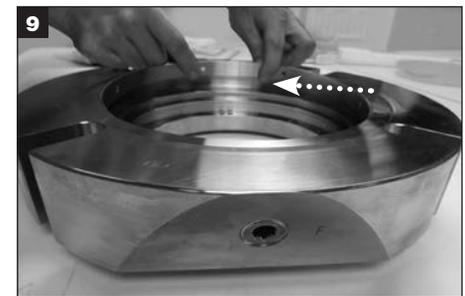
**Para sellos con la opción de inyector:** Invierta la brida. Comprima y superponga los extremos del inyector, posicione las separaciones frente al puerto F (lavado) e instale en la ranura de la brida. **IMPORTANTE: El inyector debe colocarse a presión en posición. Asegúrese de que los extremos divididos no se superpongan al quedar completamente instalados.**
