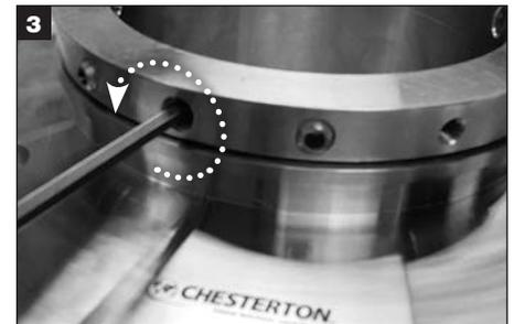
Retire todos los tornillos de fijación de macho corto y largo para quitarlos del anillo de bloqueo y deséchelos.
