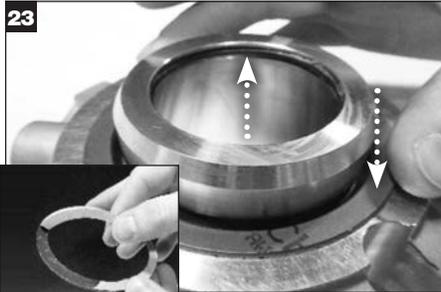
Aplique una película delgada de grasa **blanca** al O-Ring del eje (V) e instálelo en la ranura del diámetro interior del O-Ring del cilindro. Despegue la cara adhesiva de la junta de la brida e instálela en el hueco para la junta de la brida.
