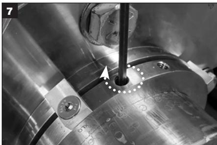
Apriete uniformemente los tornillos de fijación de macho corto ② con la llave hexagonal provista. **IMPORTANTE:** Después de haber apretado a mano todos los tornillos de fijación, vuelva a apretar con una llave de apriete: hasta 13,6 – 15,3 Nm (120 – 135 in-lbs.)
