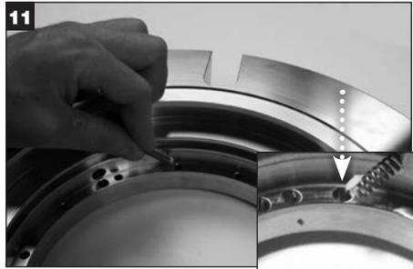
Sumerja los extremos de los resortes en **grasa blanca** e insértelos en cada orificio para resortes. **IMPORTANTE: NO inserte los resortes en los cuatro orificios uniformemente espaciados marcados mediante muescas y previamente llenados con grasa 635 SXC.**
