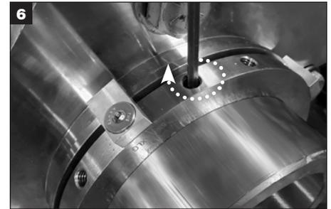
Apriete uniformemente tres tornillos de fijación de macho largo ① (consulte la imagen insertada, marcada con una muesca) con la llave hexagonal provista.
