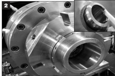
Aplique una película delgada de grasa **blanca** al O-Ring del eje (V) y deslice el sello sobre el eje empujando sobre la brida. **PRECAUCIÓN:** **Asegúrese de que todos los tornillos de fijación estén apretados en el cilindro, pero que no sobresalgan en el diámetro interno del mismo.**
