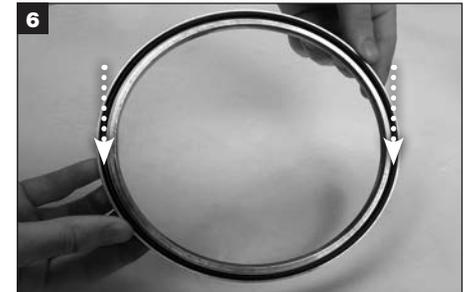
**Para sellos con el kit del buje:** Aplique una película delgada de grasa **blanca** al O-Ring del buje (Y) e instálelo en la ranura del buje de bronce. **IMPORTANTE: Asegúrese de que el O-Ring quede completamente asentado y firme dentro de la ranura correspondiente. El O-Ring podría ser demasiado grande al instalarlo y en ese caso, será necesario esforzarse para insertarlo.**
