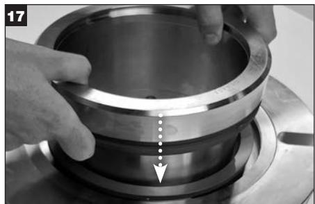
Invierta el conjunto del cilindro e insértelo en el orificio de la brida.
