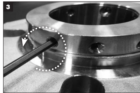
Ze zámkového kroužku odstraňte a zlikvidujte všechny stavěcí šrouby s dutým čípkem a 1/4 stavěcí šrouby s kuželovým koncem.
