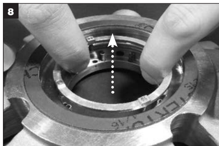
Soupravu sledovače vyjměte z příruby a odložte stranou.
