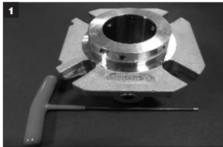
Nástroje potřebné pro demontáž ucpávky: Imbusový klíč (dodávaný s ucpávkou); pinzeta a zahnutý paklíč (dodává zákazník; na odstranění O-kroužků a řídicí hadičky).
