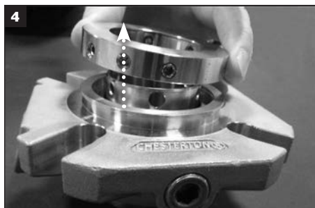
Z pouzdra vyjměte zámkový kroužek a odložte stranou.
