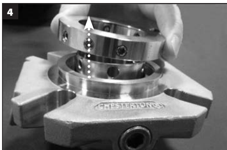
Den Klemmring aus der Hülse entfernen und zur Seite legen.
