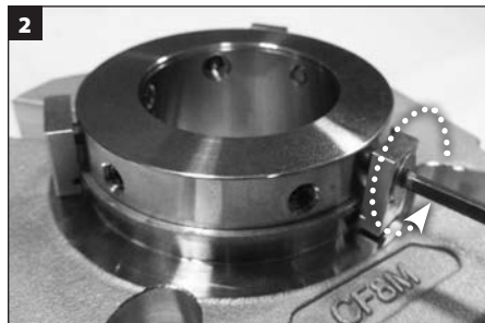
Die Zentrierklammern ausbauen und entsorgen.
