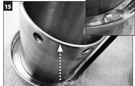
Den Mitnehmer von den Mitnehmerösen in der Hülse entfernen und entsorgen.
