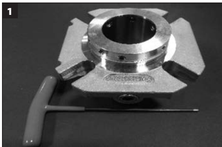
Zum Zerlegen der Dichtung erforderliche Werkzeuge: Sechskantschlüssel (mit Dichtung mitgeliefert); Pinzette und gebogener Stift (vom Kunden bereitgestellt; zum Ausbau der O-Ringe und des Mitnehmerrohrs).
