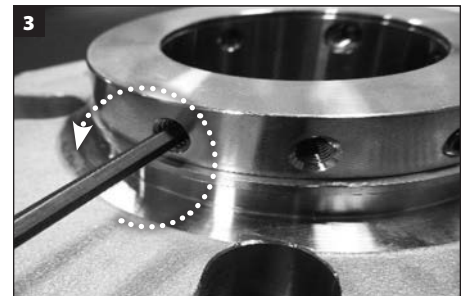
Alle Ringschneide- und 1/4-Ansatz-Einstellschrauben aus dem Klemmring entfernen und entsorgen.
