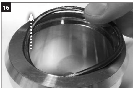
Den Wellen-O-Ring (V) von Hülse abziehen und entsorgen.
