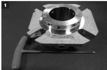
Tiivisteiden purkamiseen tarvittavat työkalut: kuusiokoloavain (toimitetaan tiivisteiden mukana), pinsetit ja kaareva piikki (asiakas hankkii, O-renkaiden ja asetusputken irrottamiseen).
