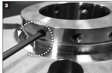
Irrota kaikki kuppikärkiset ja 1/4:n sakarakärkiset kiristysruuvit lukitusrenkaasta ja hävitä ne.
