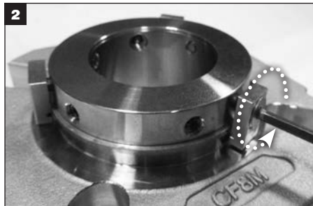
2 センタリングクリップを外し、廃棄します。
