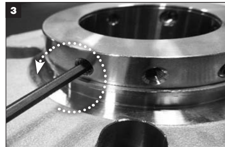
3 ロックリングからカップポイントスクリューと1/4 ドラグセットスクリューをすべて外し、廃棄します。
