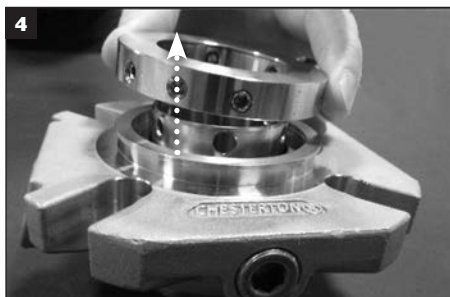
4 スリーブからロックリングを外し、脇に置きます。
