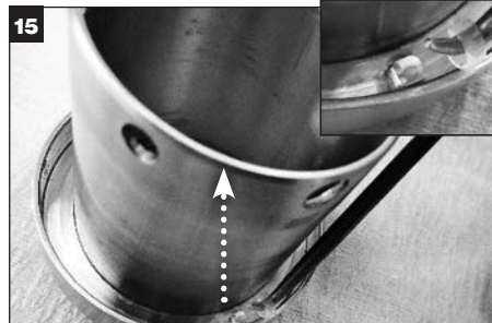
スリーブ内の駆動ラグから駆動部を外し、廃棄します。
