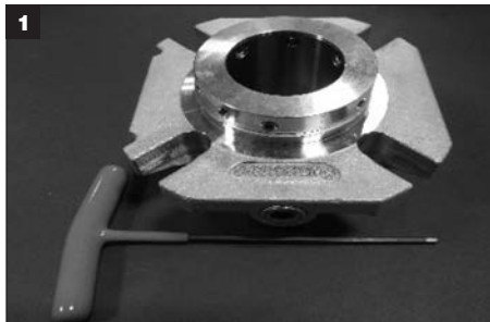
1 シールの分解に必要な工具:六角ねじ回し(シールに付属)、ピンセットと先の曲がった道具(客先手配、O-リングと駆動チューブの除去用)
