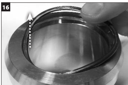
Fjern akselens o-ring (V) fra hylsen og avhend.
