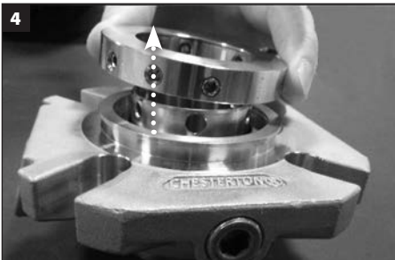
Fjern låseringen fra fra hylsen og sett den til side.
