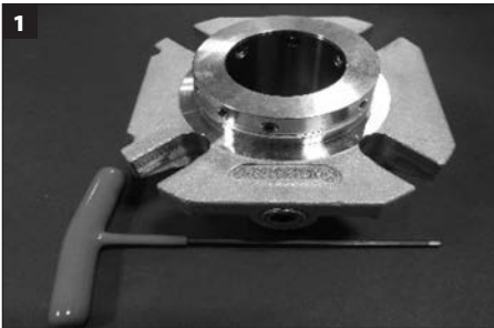
Verktøy som kreves for demontering av tetningen: Unbrakonøkkel ( levert med tetningen ); pinsett og en krom pirk ( levert av kunden; for fjerning av o-ringer og drivrør ).
