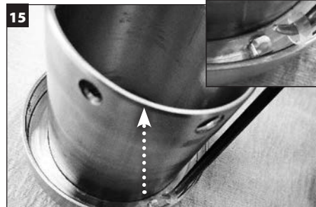
Fjern drivet fra drivmutteren i hylsen og avhend.
