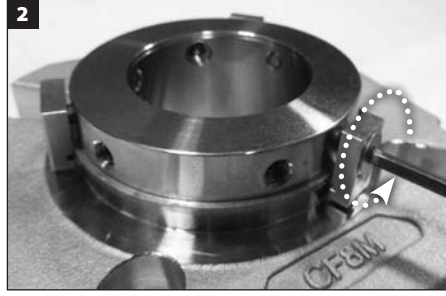
Merkezeleme klipslerini çıkarın ve atın.
