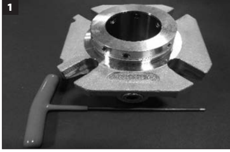
Salmastranın sökülmesi için gerekli aletler: Altigen anahtar ( salmastra ile birlikte verilir ); cımbız ve kavisli bir çekme çubuğu ( müşteri tarafından temin edilir; O-Ringlerin ve tahrik borusunun sökülmesi için ).
