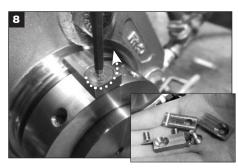
Al hacer ajustes al impulsor o al desmontar el sello, retire todos los tornillos de cabeza plana y los clips de centrado, y guárdelos para uso futuro.
