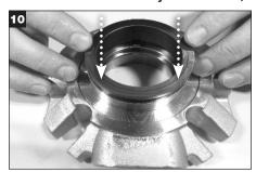
Alinee las ranuras en un anillo del sello estacionario con los clips del canal antirrotación y el deflector de flujo. Presione cuidadosamente en posición y asegúrese de que el anillo del sello quede completamente asentado.
