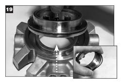
Retire el adaptador de la brida. Retire el O-Ring del Adaptador (Z) y deséchelo. Aparte el adaptador.
