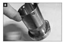
Aplique una película delgada de grasa al O-Ring Rotativo (W) e instálelo en la ranura del diámetro externo del anillo del sello rotativo externo.
