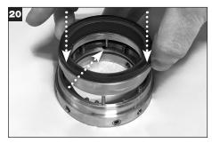
Alinee los pasadores en el conjunto de soporte con los orificios marcados en el anillo de bloqueo y presiónelo para asentar en posición.
