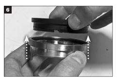
Retire el anillo del sello rotativo externo del conjunto de soporte y deséchelo.
