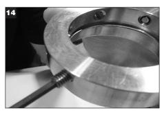
IMPORTANTE: Los tornillos de fijación no deben sobresalir hacia el diámetro interno del anillo de bloqueo antes de instalarlos en la camisa del sello.
