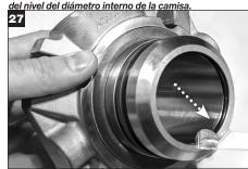
Aplique una película delgada de grasa al O-Ring del Eje (V) e insértelo en la ranura del diámetro interno de la camisa.
