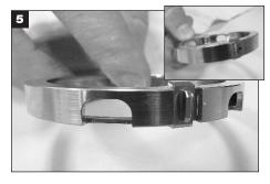
Aplique una película delgada de grasa al clip del canal de transmisión\* y al deflector de flujo del canal de transmisión. Instale el deflector de flujo del canal de transmisión en la ranura entre los dos recortes. Instale los clips del canal de transmisión en las ranuras restantes. \*NOTA: Tamaños del sello
