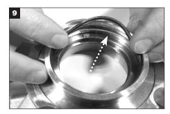
Aplique una película delgada de grasa al O-Ring Estacionario (X) e instálelo en la ranura del diámetro interno en el adaptador.
