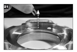
Retire el conjunto de transmisión de la brida y deséchelo.
