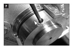
Apriete los tornillos de fijación de punta redonda de manera uniforme, usando la llave hexagonal provista. IMPORTANTE: Después de haber apretado todos los tornillos de fijación a mano, vuelva a apretar con una llave dinamométrica:
