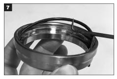
Retire el O-Ring rotativo externo (W) del conjunto de soporte y deséchelo.
