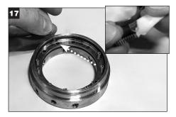
Aplique una pequeña cantidad de grasa a un extremo de cada resorte e insértelo en los orificios sin marcar del anillo de bloqueo. PRECAUCIÓN: NO instale los resortes en los orificios marcados destinados para los pasadores de la placa del soporte.
