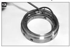
Retire el O-Ring del soporte del anillo de bloqueo (U) y deséchelo.
