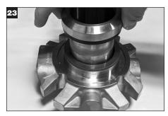
Invierta el conjunto de la camisa, sujetando alrededor del diámetro externo del conjunto de la camisa y deslícelo sobre la brida y los conjuntos de anillos de bloqueo. IMPORTANTE: La muesca en el extremo de la camisa deberá alinearse con los tres puntos verticales en el diámetro externo del anillo de bloqueo cuando se haya instalado correctamente.
