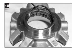
Retire el O-Ring Estacionario (X) interno del adaptador y deséchelo.
