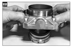
Coloque la brida sobre el conjunto de anillos de bloqueo, con la marca de Chesterton orientada hacia abajo, y alinee la cara del anillo estacionario con la cara del anillo del sello rotativo.
