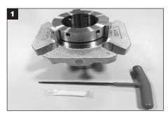
Herramientas requeridas para la instalación: Llave hexagonal y grasa (suministrada con el sello). Llave de extremó abierto o tubular/dinamométrica (el tamaño depende del tamaño del perno de montaje; suministrada por el cliente.
