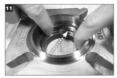
Invierta cuidadosamente la brida y colóquela sobre un paño limpio para proteger la superficie del anillo de sellado interno. Aplique una película delgada de grasa al O-Ring Estacionario (X) restante e instálelo en la ranura del diámetro interno en la brida.
