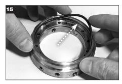
Aplique una película delgada de grasa al O-Ring del soporte del anillo de bloqueo (U) e insértelo en la ranura del diámetro interno más grande del anillo de bloqueo.
