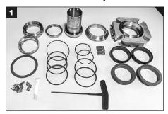
Herramientas requeridas para el montaje del sello: Llave hexagonal y grasa (suministrados con el sello); paño sin pelusa, tenacillas o un pico delgado (suministrados por el cliente; para instalar los O-Rings). Limpie todos los componentes metálicos con un solvente aprobado, incluidas todas las superficies de las juntas y de los O-Rings. Coloque los componentes metálicos y todos los componentes del sello de repuesto sobre una superficie limpia y seca.
