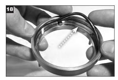
Aplique una película delgada de grasa al O-Ring rotativo externo (W) e insértelo en la ranura del diámetro interno del anillo del conjunto de soporte.
