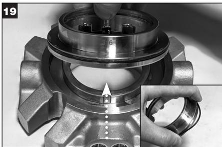
19 Déposez l'adaptateur du chapeau. Déposez le joint torique de l'adaptateur (Z) et mettez-le au rebut. Mettez l'adaptateur de côté.
