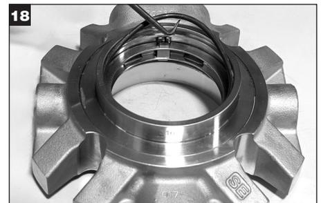
18 Déposez le joint torique stationnaire (X) interne de l'adaptateur et mettez-le au rebut.
