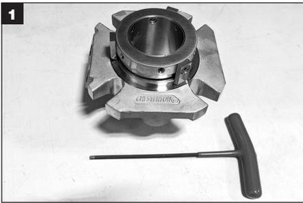
Outils nécessaires au démontage de la garniture mécanique : Clé hexagonale (fournie avec la garniture mécanique) ; pince ou pic incurvé (non fournis ; pour la dépose des joints toriques).
