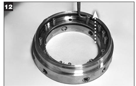
Déposez tous les ressorts de la bague de verrouillage et mettez-les au rebut.
