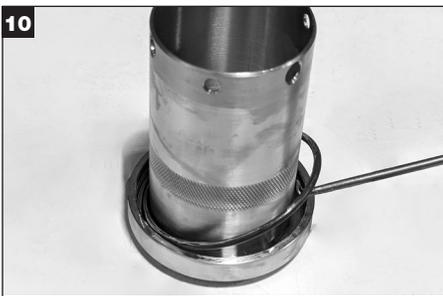
Déposez le joint torique tournant (W) interne de la chemise et mettez-le au rebut.
