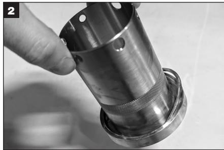
Appliquez une fine couche de graisse sur le joint torique tournant (W) et montez-le dans la rainure du diamètre intérieur de la chemise.
