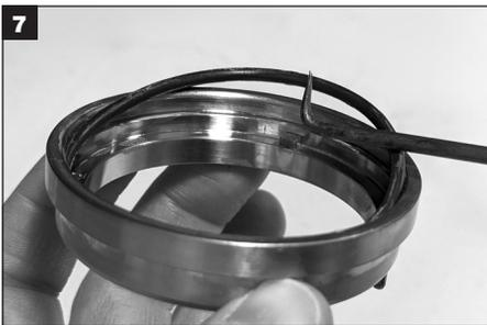
Déposez le joint torique tournant (W) externe du manchon de maintien et mettez-le au rebut.
