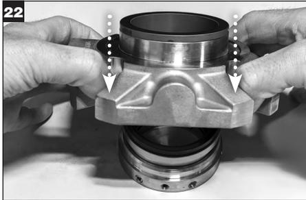
Placez le chapeau sur la bague de verrouillage, marquage Chesterton vers le bas, et alignez la face de la bague d'étanchéité stationnaire avec la face de la bague d'étanchéité tournante.
