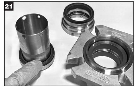
Nettoyez toutes les surfaces des bagues d'étanchéité avec un chiffon propre et un solvant agréé avant l'assemblage final des composants.
