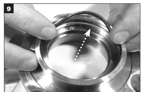
Applicare uno strato sottile di grasso all'O-ring della faccia stazionaria (X) e inserirlo nella scanalatura nel diametro interno dell'adattatore.
