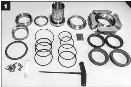
Utensili necessari per il montaggio della tenuta: Chiave a brugola e grasso (forniti con la tenuta); panno senza filacce, pinzette o punteruolo (forniti dal cliente; per l'installazione degli O-ring). Pulire con un solvente approvato tutti i componenti metallici, comprese tutte le guarnizioni e le superfici degli O-ring. Posizionare i componenti metallici e tutte le parti di ricambio della tenuta su una superficie pulita e asciutta.
