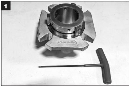
Utensili necessari per lo smontaggio della tenuta: Chiave a brugola (fornita con la tenuta); pinzette o punteruolo curvo (forniti dal cliente; per la rimozione degli O-Ring).
