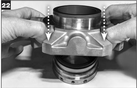
Posizionare la flangia sul gruppo dell'anello di blocco, con la scritta Chesterton rivolta verso il basso, e allineare la faccia dell'anello di tenuta della faccia stazionaria con la faccia dell'anello di tenuta della faccia rotante.
