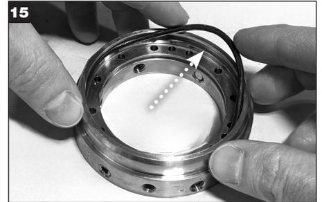
Applicare uno strato sottile di grasso sull'O-ring dell'anello di blocco del supporto (U) e inserirlo nella scanalatura più grande sul diametro interno dell'anello di blocco.
