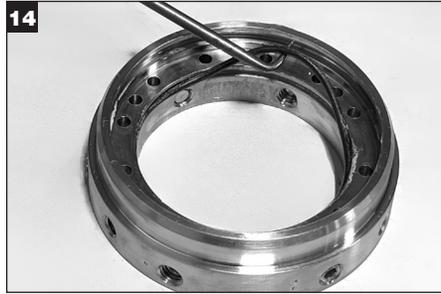
14 Rimuovere l'O-ring dell'anello di blocco della bussola (Y) ed eliminarlo.
