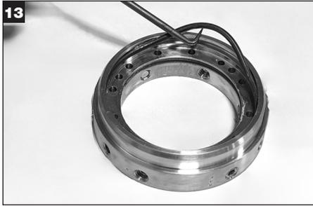
13 Rimuovere l'O-ring dell'anello di blocco del supporto (U) ed eliminarlo.
