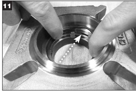
Inverta cuidadosamente a sobreposta e coloque-a sobre um pano limpo para proteger a superfície interna do anel do selo. Aplique uma película fina de graxa ao O-ring estacionário (X) restante e instale-o na ranhura do diâmetro interno da sobreposta.
