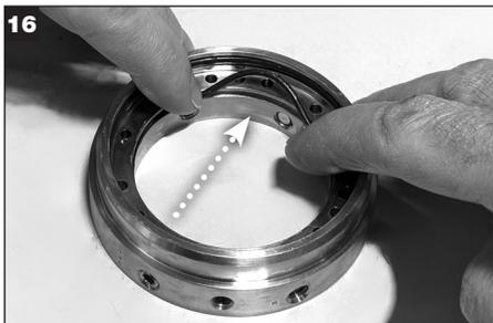
Aplique uma película fina de graxa no O-ring da luva do anel de trava (Y) e insira-o na ranhura de menor diâmetro interno do anel de trava.
