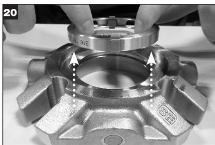
20 Remova o canal de acionamento da sobreposta; remova e descarte os grampos do canal e o defletor de fluxo.
