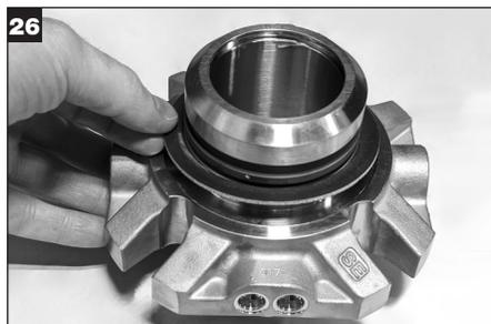
Instale a junta da caixa de selagem no rebaixo da sobreposta.
