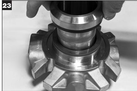
Inverta o conjunto da luva, segurando em torno do diâmetro externo do conjunto da luva, e deslize-o para dentro dos conjuntos do anel de trava e sobreposta. **IMPORTANTE: Quando a instalação estiver correta, o entalhe na extremidade da luva deve estar alinhado com os três pontos verticais no diâmetro externo do anel de trava.**
