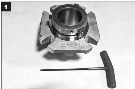
Ferramentas necessárias para a desmontagem do selo: Chave Allen (**fornecida com o selo**); pinças ou uma ferramenta fina de ponta curva (**fornecidas pelo cliente para a remoção de O-rings**).
