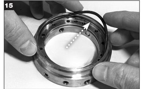
Aplique uma película fina de graxa no O-ring de suporte do anel de trava (U) e insira-o na ranhura de maior diâmetro interno do anel de trava.
