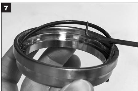
Remova e descarte o O-ring rotativo externo (W) do conjunto de suporte.
