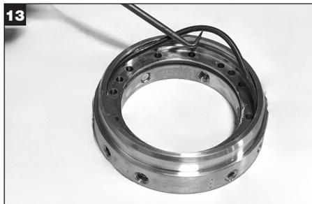
13 Remova e descarte o O-ring de suporte do anel de trava (U).
