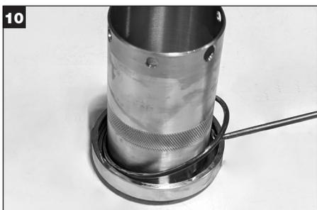
Remova e descarte o O-ring rotativo interno (W) da luva.
