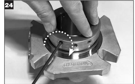
Segure todo o conjunto do selo e inverta-o cuidadosamente; gire e coloque-o sobre uma superfície de trabalho limpa. Pressione firmemente a parte superior do anel de trava e encaixe os parafusos Allen de 1/4 nos pequenos furos da luva. Aperte os parafusos Allen de 1/4 uniformemente para manter o anel de trava centrado corretamente com a luva. **CUIDADO: NÃO desvie a luva apertando demasiadamente os parafusos Allen de 1/4. Esses parafusos não devem se projetar além do diâmetro interno da luva.**
