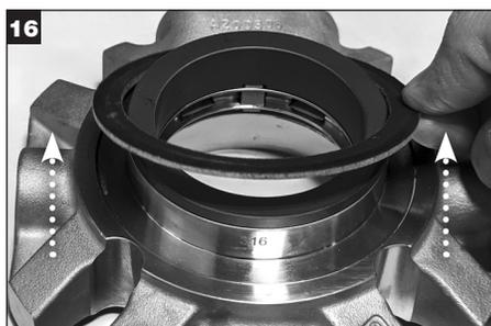
16 Remova e descarte a junta do adaptador.
