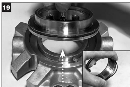
19 Remova o adaptador da sobreposta. Remova e descarte o O-ring do adaptador (Z). Deixe o adaptador de lado.
