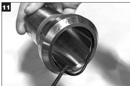
Remova e descarte o O-ring do eixo (V) da luva.
