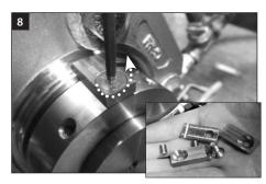
卸下所有平头螺钉和定心夹,保留以备将来 调整叶轮和/或拆卸密封件时使用。
