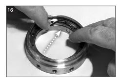
在定位環軸套 O 型環 (Y) 上塗抹一層的潤滑 脂薄膜,然後將其插入內徑較小的定位環凹 槽中。
