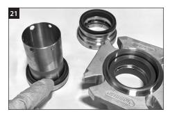
最终组装部件之前,用干净的布和经批准的溶剂清洁所有密封环表面。
