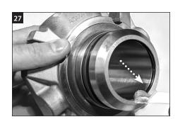
在軸 O 型環 (V) 上塗抹一層潤滑脂薄膜,並 將其插入軸套內徑的凹槽中。
