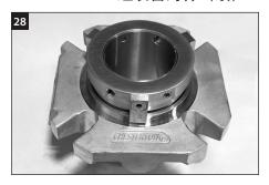
到此,密封件复原完成。可以安装密封件。
