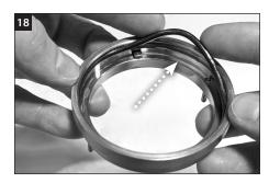
在外側回轉 O 型環 (W) 上塗抹一層潤滑脂 薄膜,並將其插入內徑較大的支架組件凹槽 中。
