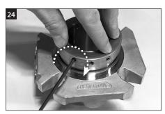
握住整個密封組件,小心地將其翻轉、旋轉並放在乾淨的工作面上。用力按住定位環頂部,將 1/4 夾頭定位螺栓擰入軸套的小孔中。均匀擰緊 1/4 夾頭螺栓,以保持定位環與軸套正確對中。小心:切勿因過度擰緊 1/4 夾頭定位螺栓而導致軸套偏移。1/4 夾頭定位螺栓不得從軸套內徑伸出。
