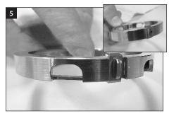
在傳動溝槽夾\*和傳動溝槽導流板上塗抹一層 潤滑脂薄膜。將傳動溝槽導流板安裝在兩個 切口之間的槽中。将传动沟槽夹安裝到剩余 的槽中。
