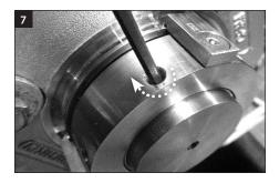
用随附的六角扳手均匀拧紧圆端定位螺栓②。 重要事項:用手擰緊所有定位螺栓後,用扭矩 扳手再次擰緊:
