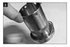
在回转 O 型环 (W) 上涂抹一层润滑脂薄膜并 将其安装到轴套组件内径的凹槽中。
