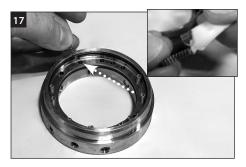
在每個彈簧的一端塗抹少量潤滑脂,然後插入定位環上無標記的孔中。小心:切勿將彈 簧安裝到用於支架組件銷釘的帶標記的孔中。 中。
