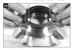
將一個靜密封環上的槽與防旋轉溝槽夾和導 流板對齊。小心按壓到位,確保密封環完全 到位。
