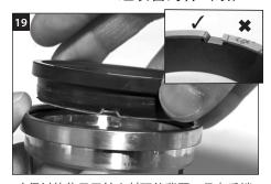
确保衬垫位于回转密封环的背面,且卡舌端插入传动槽。將回轉密封環的傳動溝槽與支架組件的凸耳對齊;輕輕按壓回轉密封環, 使其到達支架組件中的正確位置。
