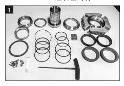
組裝密封件所需工具:六角扳手和润滑脂 (随密封件提供);无绒布、镊子或细拾取器(用户自备;用于安装O型环)。使用經 批准的溶劑清洗所有金屬部件,包括所有墊 片和O型環表面。將金屬部件和所有備用密 封部件放在乾淨乾燥的表面上。
