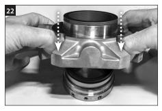
將壓蓋放在定位環元件上,Chesterton 標 記朝下,將靜密封環端面與回轉密封環端 面對齊。
