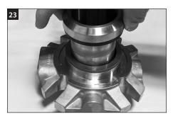
翻轉軸套元件,握住軸套元件的外徑,將 其滑入壓蓋和定位環組件。重要事項:正 確安裝後,軸套末端的切口應與定位環外 徑上的三個垂直點對齊。
