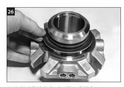
将密封腔垫片安装到压盖凹进处中。
