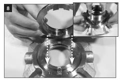
將適配器槽與傳動溝槽和壓蓋上的槽對齊。 将适配器推入到位。重要事項:適配器表面 必須低於壓蓋表面,以便完全到位和正確安 裝。
