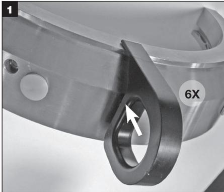
Sortez la garniture mécanique de son emballage et démontez-la sur la surface de travail propre. Pour de plus amples détails, **consultez la Préparation de la garniture mécanique, à la page 2.** Installez les entretoises en P dans les orifices, sur le diamètre extérieur des moitiés du manchon. **Remarque :** Cela peut être réalisé lorsque le manchon est monté sur l'arbre.
