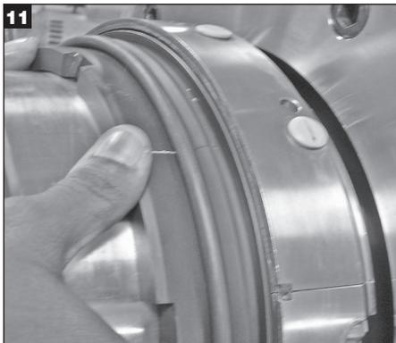
Appuyez de manière homogène au dos de la face de frottement stationnaire pour insérer les fentes de la face de frottement tournante dans les pattes d'entraînement. Si l'insertion est correctement réalisée, la surface de la face tournante à la séparation doit être lisse, sans décalage ni rugosité. Essuyez les surfaces des faces de frottement pour qu'elles soient propres, en vous assurant de supprimer toute empreinte de doigts graisseuse déposée pendant l'installation.
